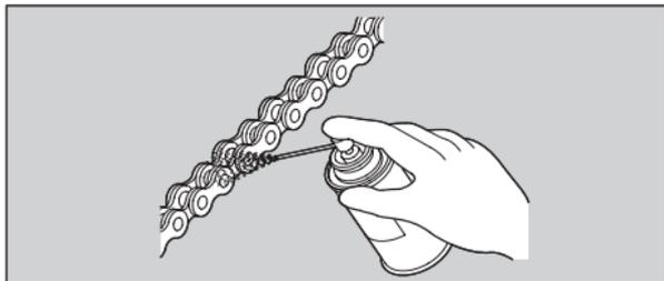
チェーンは、ゴムのシールを使用しているため、スチーム / 高圧洗浄、ワイヤーブラシ、ガソリンやベンゼンなどの揮発性溶剤、研磨材が入っている洗剤は使用しないでください。
