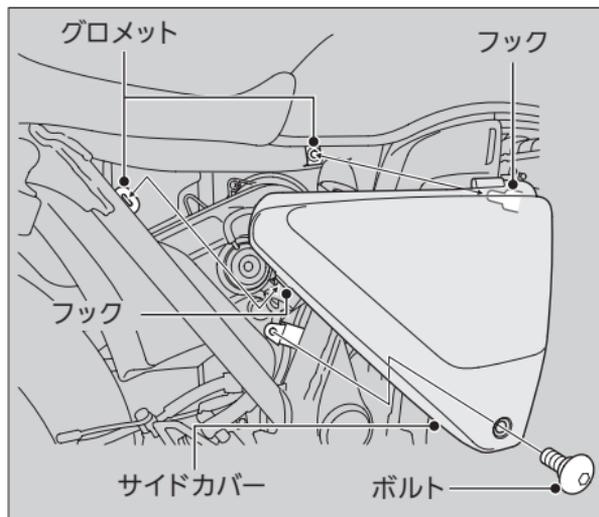
ヒューズ切れの確認は、左サイドカバーを取り外して行います。エアクリーナーの点検は、右サイドカバーを取り外して行います。
